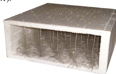
Рисунок 1.1 – Пенопластовый блок, содержащий конусовидные элементы из стекловолокна
