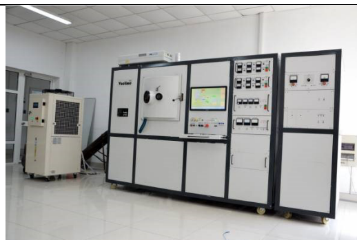
Рисунок 5.1 – Вакуумная установка для нанесения углеродных покрытий методом импульсного катодно-дугового распыления (2013)
