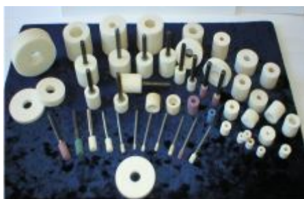
Рисунок 2.3 – Абразивный шлифовальный инструмент повышенной стойкости на керамической связке из первичного и вторичного абразива
