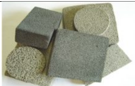
Рисунок 2.2 – Пеностекло на основе аэросила технического (отходов Гомельского химзавода) в виде легких и теплых строительных блоков
