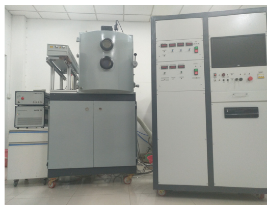
Рисунок 5.2 – Вакуумная установка для нанесения полимерных нанокomпозиционных покрытий из газовой фазы методом электронно-лучевого диспергирования (2017)
